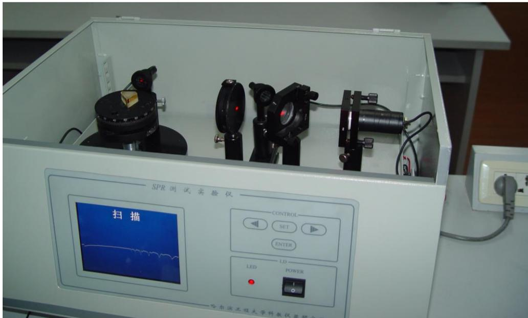
表面等离子体共振（SPR）是一种物理光学现象。表面等离子体共振检测是一种利用表面等离子体波（SPW, Surface Plasma Wave）进行检测的技术，它具有无须标记、高速化、专一性、灵敏度高以及大量平行筛选等优点。表面等离子体（SP）是沿着金属和电介质间界面传播的电磁波形成的。当平行表面的偏振光以称之为表面等离子体共振角入射在界面上，发生衰减全反射时，入射光被耦合入表面等离子体内，光能大量被吸收，在这个角度上由于表面等离子体共振引起界面反射光显著减少。由于SPR对金属表面电介质的折射率非常敏感，不同电介质其表面等离子体共振角不同。同种电介质，其附在金属表面的量不同，则SPR的响应强度不同。基于这种原理，表面等离子体光学生物检测系统可实现波导等薄膜材料的折射率和厚度的测量，薄膜、波导材料双折射率的测量和吸收材料的折射率和厚度测量等。
